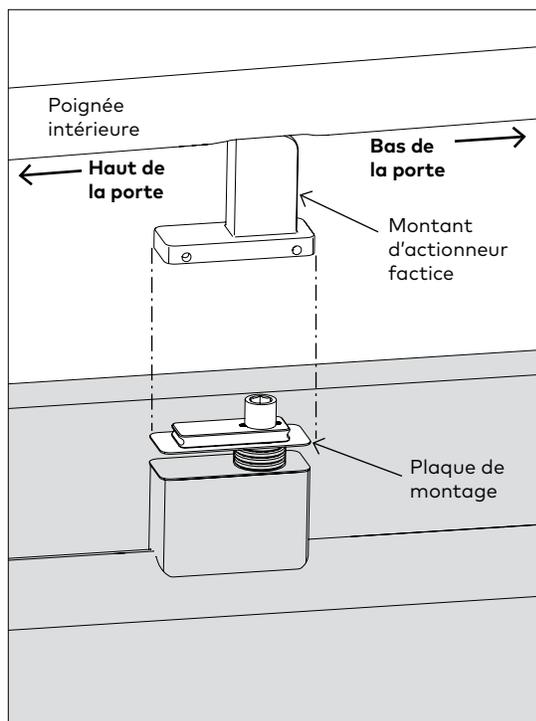
2.6.2 Placer le montant de l'actionneur factice sur le dessus de la plaque de montage.
