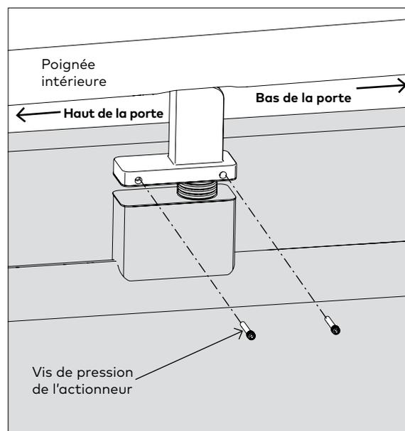
2.6.3 Fixer le montant de l'actionneur factice à la plaque de montage avec les deux vis de pression fournies.
