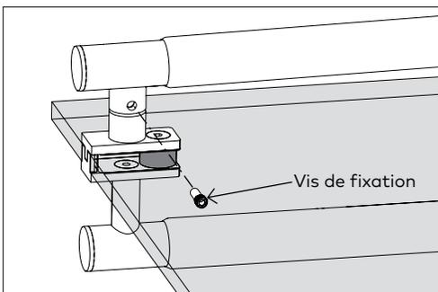
2.7.2 Fixer à la plaque de montage intérieure sur verre à l'aide de la vis de fixation.
