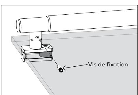
2.7.2 Fixer à la plaque de montage intérieure sur verre à l'aide de la vis de fixation.
