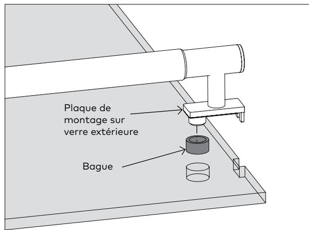
2.4.2 Placer la bague sur la plaque de montage extérieure sur verre.
